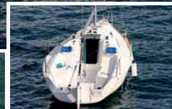
Sopra, il pozzetto, la cui ampiezza è valorizzata dalla poppa aperta. A sinistra, anche con poca aria, lo spinnaker assicura una buona andatura
